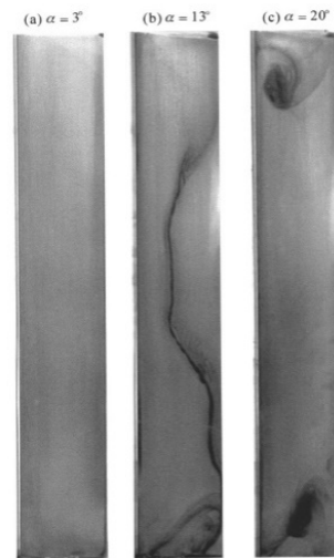
受控制的機翼表面油墨流
