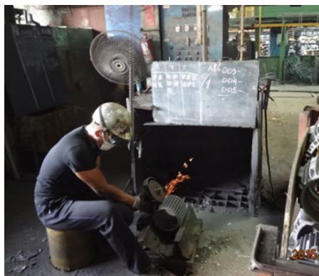
改善前鑄造廠馬達鑄件外殼打磨作業 改善前粉塵濃度： 6.90 \text{ mg/m}^3
